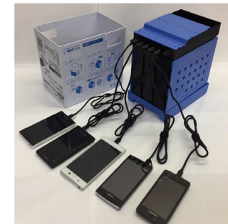
災害発生時のスマートフォン等への充電の重要性に着目し、非常用簡易発電機を設置
